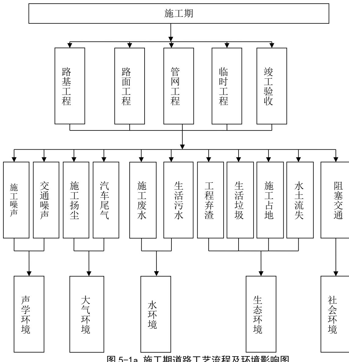
图 5-1a 施工期道路工艺流程及环境影响图
