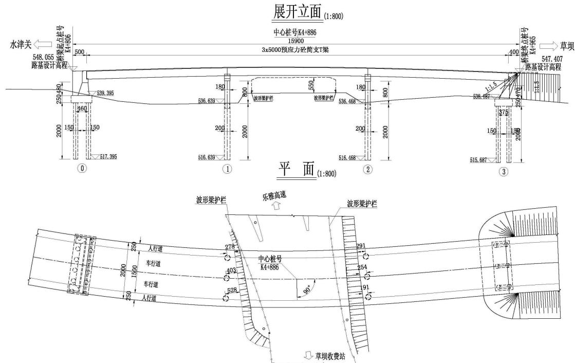
图 1-6 草坝跨线大桥平面图
