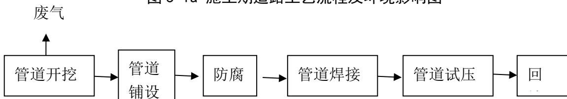
图 5-1b 施工期管道施工工艺流程及环境影响图
