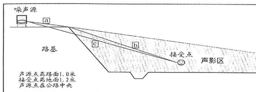
图 7-2 声程差  $\delta$  的计算示意图
