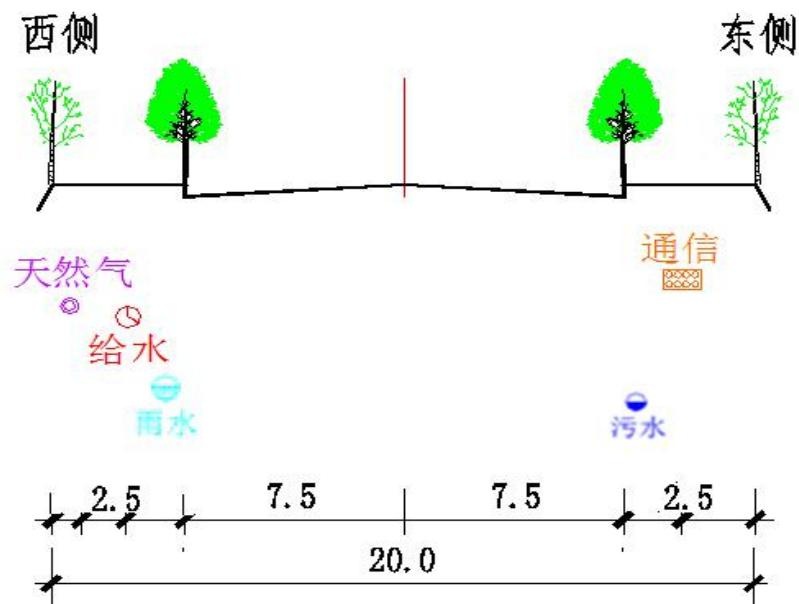
图 1-4 管道布置衡断面图
