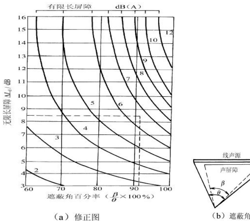
图 7-1 有限长度的声屏障及线声源的修正图
