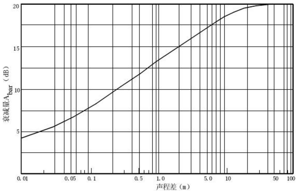
图 7-3 噪声衰减量  $A_{bar}$  与声程差  $\delta$  关系曲线( $f=500HZ$ )
